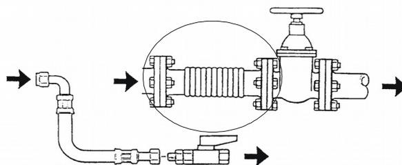
Перед пуском отсекающий кран обязательно должен быть открытым. Трубопроводы следует укладывать с уклоном 0,005 в сторону линейных влагоотделителей.
