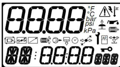
Рис. 1. Дисплей контроллера
