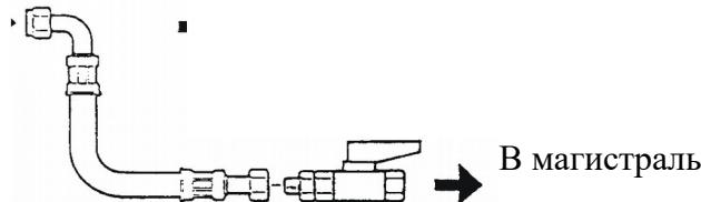
Перед пуском отсекающий кран обязательно должен быть открыт. Трубопроводы следует укладывать с уклоном 0,005 в сторону линейных влагоотделителей.
